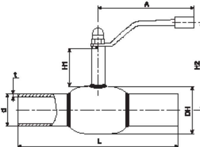
**Серия КШТ 60.112, DN 50 - 80 PN 25 сварка/сварка (полный проход)**
