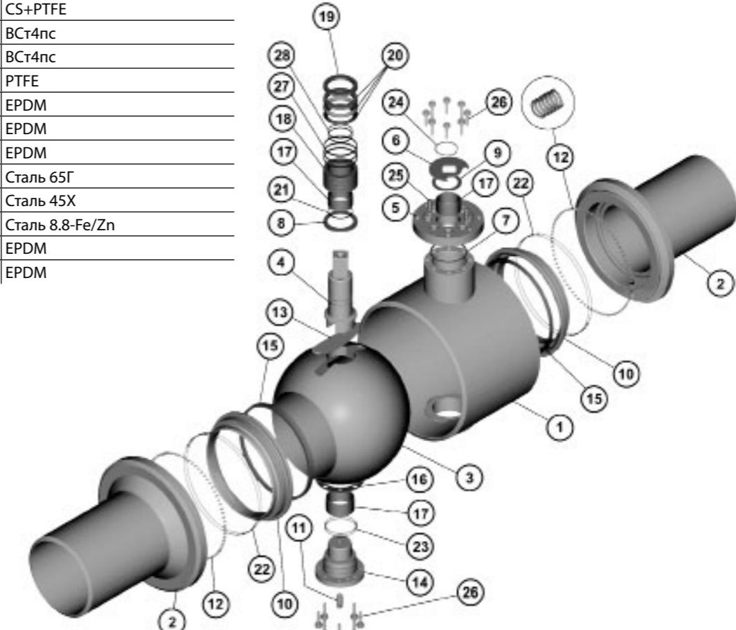
**Серия КШТ 60.002, DN 15 - 150 PN 16 сварка/сварка (стандартный проход)**
